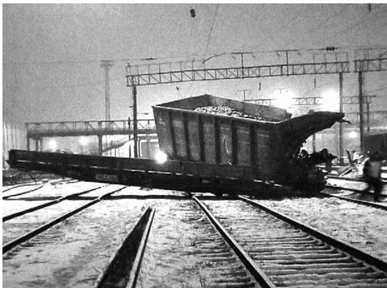
9 снежня ў Баранавічах сышлі з рэк тры вагоны грузавага цягніка. Прычына здарэння — самарасчэп вагонаў. Цягнік перавозіў жалезабетонныя вырабы і вугаль. Ніхто не пацярпеў. Вагоны моцна пашкоджаныя.
